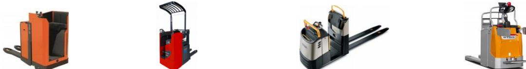
Chariot muni de bras de fourche, pouvant élever une charge à une hauteur suffisante pour permettre son transport ou la préparation de commande au sol (inclus ceux équipés d'une plate-forme rabattable).
