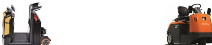
Chariot de manutention muni d'un système d'attelage et spécialement conçu pour tirer des véhicules roulants (remorques...), dont la capacité de traction est inférieure ou égale à 25 tonnes.
