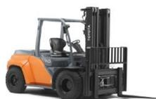
Chariot élévateur à mât muni de bras de fourche, sur lesquels la charge est placée en porte-à-faux par rapport aux roues et est équilibrée par la masse du chariot, dont la capacité nominale est supérieure à 6 tonnes.
