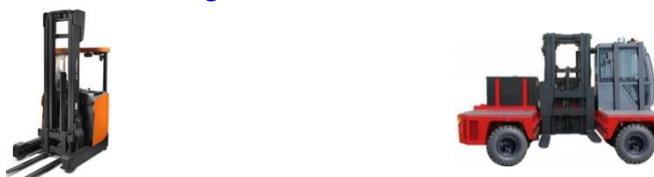
Chariot élévateur gerbeur à longerons porteurs pour lequel la charge peut être amenée en porte-à-faux par avancement du mât (inclus les chariots à prise latérale d'un seul côté).
