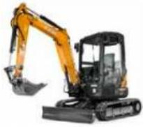
Pelles hydrauliques à chenilles ou sur pneumatiques, de masses ≤ 6 tonnes
