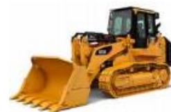
Chargeuses à chenilles de masse > 6 tonnes.
