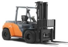
Chariot élévateur à mât muni de bras de fourche, sur lesquels la charge est placée en porte-à-faux par rapport aux roues et est équilibrée par la masse du chariot, dont la capacité nominale est supérieure à 6 tonnes.
