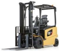
Chariot élévateur à mât muni de bras de fourche, sur lesquels la charge est placée en porte-à-faux par rapport aux roues et est équilibrée par la masse du chariot, dont la capacité nominale est inférieure ou égale à 6 tonnes.
